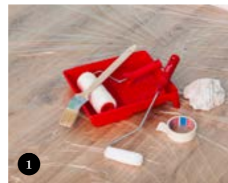
1 Για το βάψιμο θα χρειαστείτε αυτά τα σύνεργα: σκαφάκι χρώματος, μεγάλο και μικρό ρολό, πινέλο για τις γωνίες και πανί.
