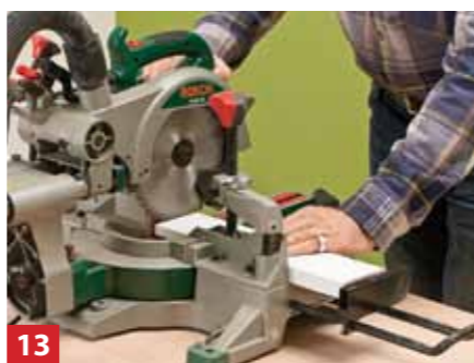
13 Μετά κόψτε τις με το φαλτσοπρίονο στο κατάλληλο μήκος. Στο υπόδειγμά μας το μήκος αυτό είναι 35 εκ.
